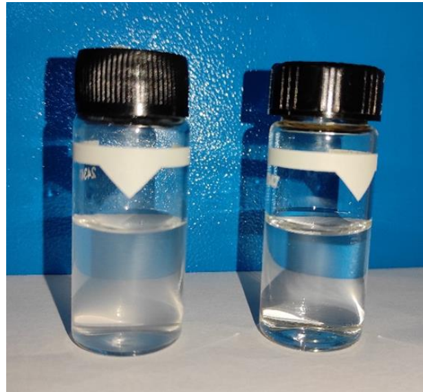
Şekil 3. Filtrasyon testleri öncesi (solda) ve sonrası (sağda) bulanıklık durumu
