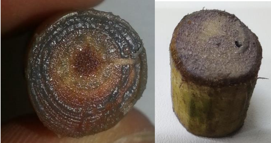
Şekil 4. Filtre yüzeyinde oluşan kek tabakası, fıstık çamı (solda) ve kavak (sağda)
