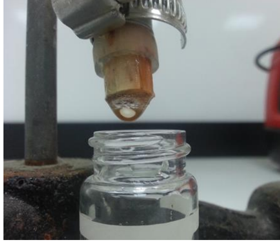
Şekil 2. Filtrasyon modülüne yerleştirilmiş filtrenin çalışma altındaki görünümü
