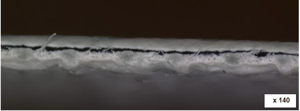
Şekil 1. Referans kaplamanın ara kesit görüntüsü
