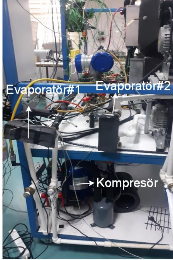
Şekil 2: Evaporatör#1 ve evaporatör#2
