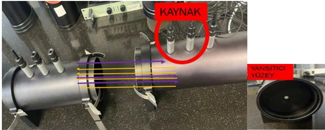
Şekil 5. Absorpsiyon Test Düzeneği
