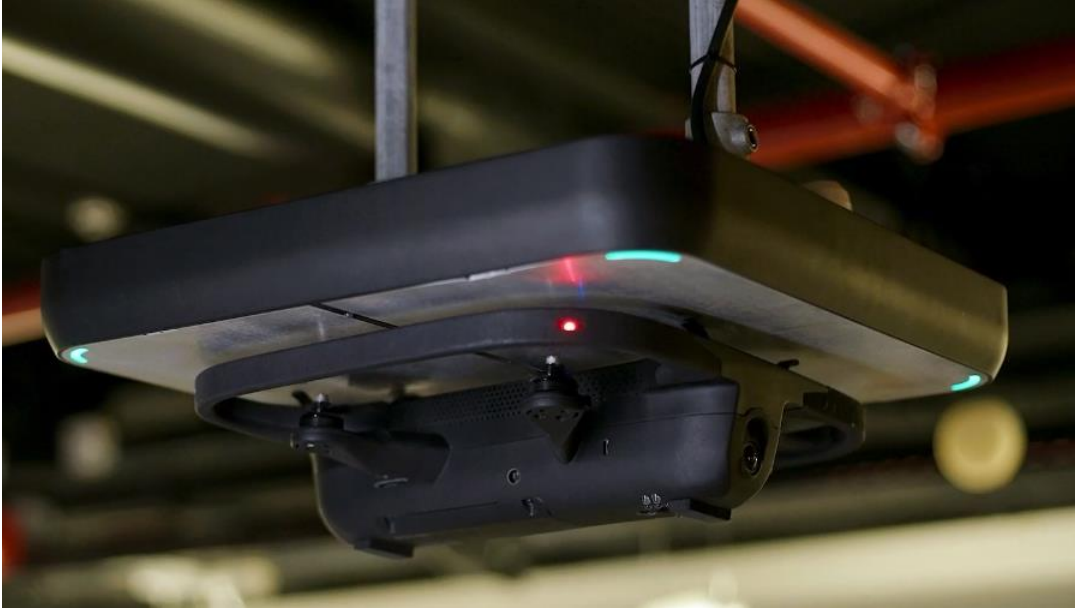
Şekil 12. İç Mekan drone kablosuz şarj istasyonu [14]
