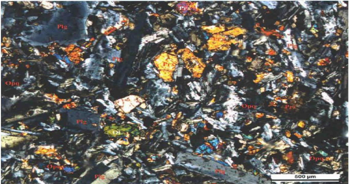
Görsel 4. Diyabaz taşının mikroskop altında görünüşü (Plg: plagioclase, Prx: Pyroxene, Ol: Olivine, Opq: Opaque mineral)
