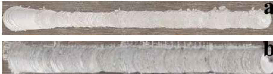
Görsel 2. a) Takviyesiz Ti 13 Nb 13 Zr alaşımı, b) HA takviyeli Ti 13 Nb 13 Zr/HA kompozit
