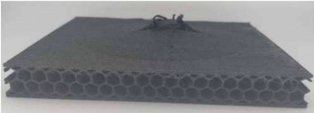
Görsel 4. CF+TPU Numunesinde Oluşan Delinme Hasarı
