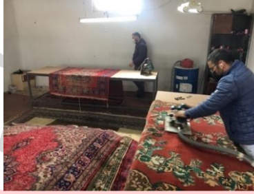
Görsel 5. Masaüstü silindir bıçaklı tıraş makinesiyle havların kısaltılması
