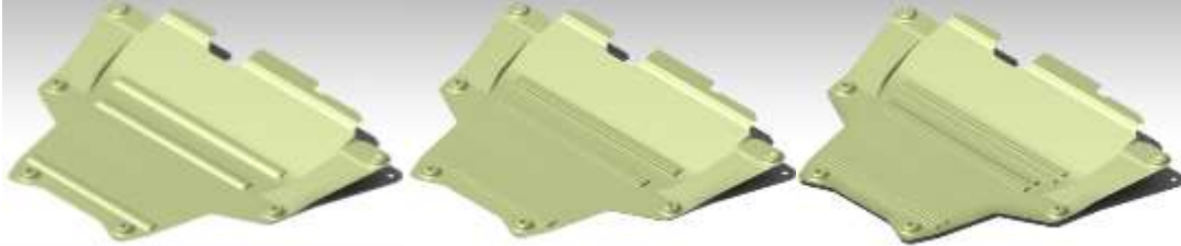
Görsel 9. Yatayda 15 ve 30 mm'lik genişlikteki dairesel ve yamuk kesite sahip kabartma örnekleri
