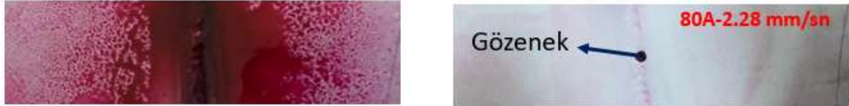
Görsel 4. Tahribatsız muayene görüntüsü 80 Amper – 2.28 mm/sn
