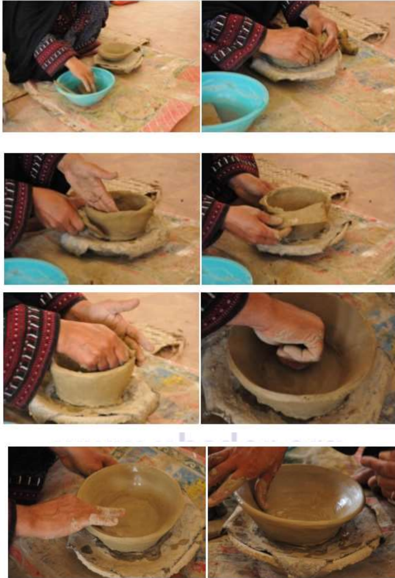
Şekil4. Sucuk Yöntemi İle Çömlek Şekillendirme Aşamaları.
