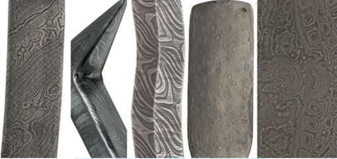
Görsel 9: Yusuf Bayyigit tarafından farklı katlama yöntemleri ile yapılmış Şam çeliği örnekleri.
